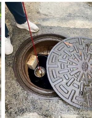
ภาพที่ 72 แสดงจุดเก็บน้ำทิ้งหลังบำบัด (Effluent)
